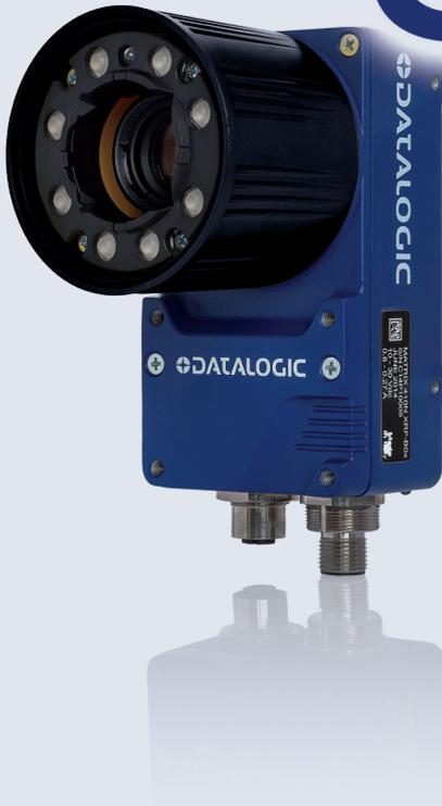
Matrix 410N 은 초당 45 프레임의 프레임 속도로 2.0메가픽셀의 해상도를 자랑하는 초고속 이미지 센서가 탑재되어 물류 및 유통 분야에서 가장 복잡한 추적 환경까지 해결할 수 있도록 개발된 산업용 2D 이미지 바코드 스캐너입니다.
